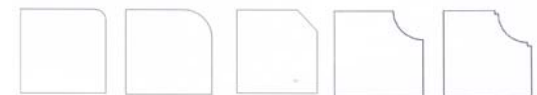
Standard Eased Edge Large Radius Edge Chamfered Edge Cove Edge Stepped Cove Edge
